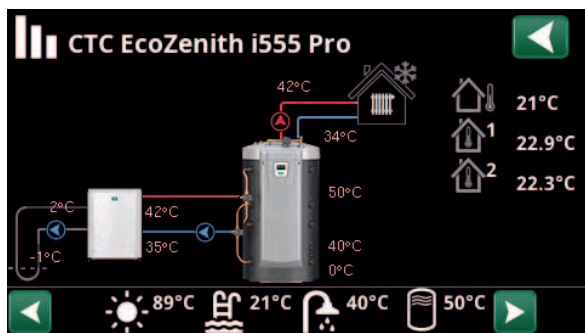
Strona menu głównego obszaru „Dane pracy” z podłączoną pompą ciepła gruntowa CTC EcoPart. Gdy pompy pracują, wirują także widniejące na ekranie ikony pomp.
