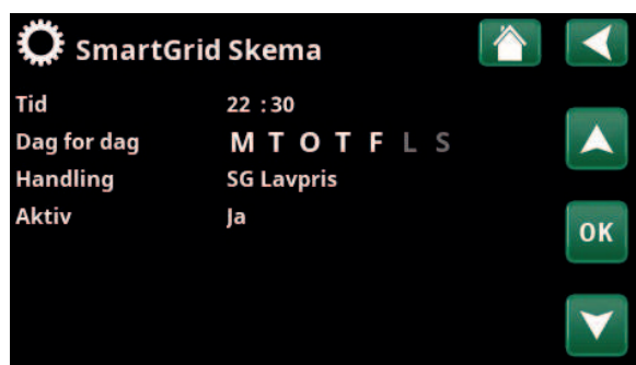
SmartGrid-funktionen "SG Lavpris" er planlagt til hverdage kl. 22.30-06.00. Gå til menuen ved at vælge "SmartGrid skema" i menuen "Avanceret/Indstillinger".
