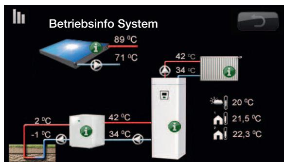
Der Bildschirm zeigt die Betriebsdaten mit angeschlossener CTC EcoPart Wärmepumpe.
