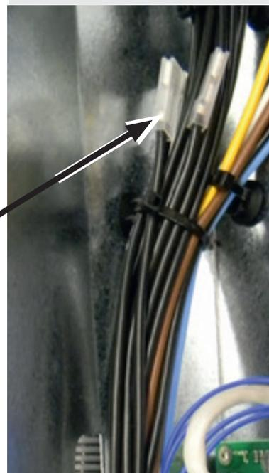
3. Lösen Sie den kleinsten Schalter (K2 auf dem Schaltplan) durch Zurückziehen der gelben Befestigung.
