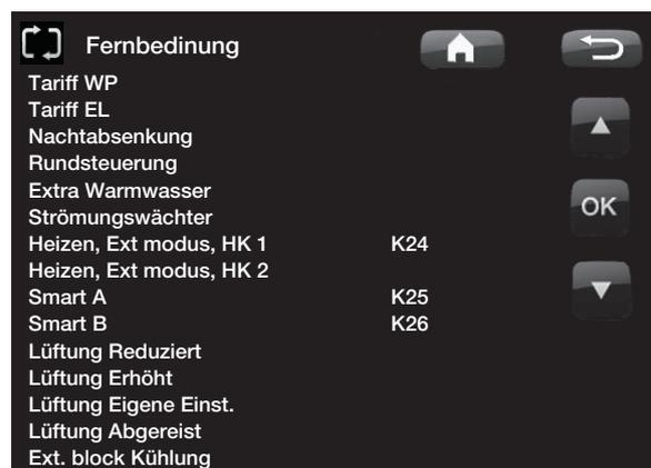
In diesem Beispiel wurde der Funktion „Heizung modus, ext HK1“ die Klemme „K24“ für die Fernbedienung zugewiesen.
