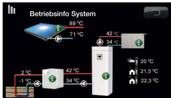
Der Bildschirm zeigt die Betriebsdaten mit angeschlossener CTC EcoPart. Wenn die Pumpen in Betrieb sind, drehen sich die Pumpensymbole auf dem Bildschirm.
