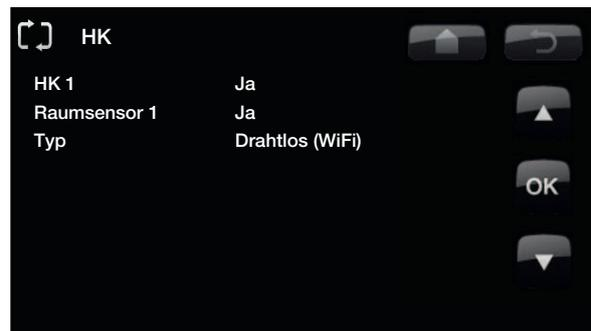
Nach der Installation/Definition des CTC SmartControl-Zubehörs kann auch ein Fühler aus der CTC SmartControl-Serie als Raumfühler verwendet werden. In diesem Fall muss SmartControl im Menü Typ ausgewählt werden. Informationen zu den Funktionen und Einstellungen von CTC SmartControl entnehmen Sie der entsprechenden Anleitung.
