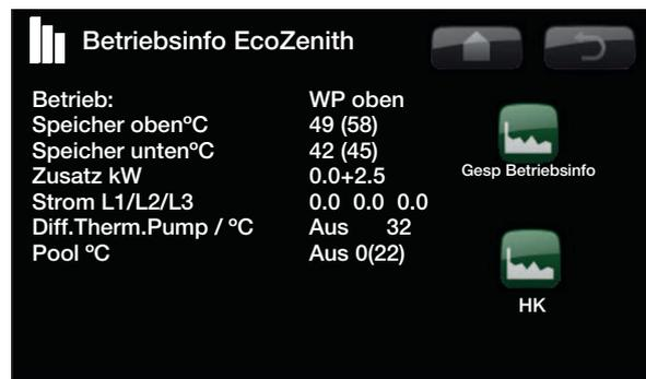
Wenn die Stromfühler (SF) angeschlossen sind und erkannt werden, werden drei Stromwerte angezeigt. Wenn nur eine Zahl angezeigt wird:
