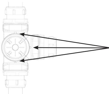
! OBS! Anslut ■ mot övre tank, ▲ mot nedre tank och ● mot extern tank.
