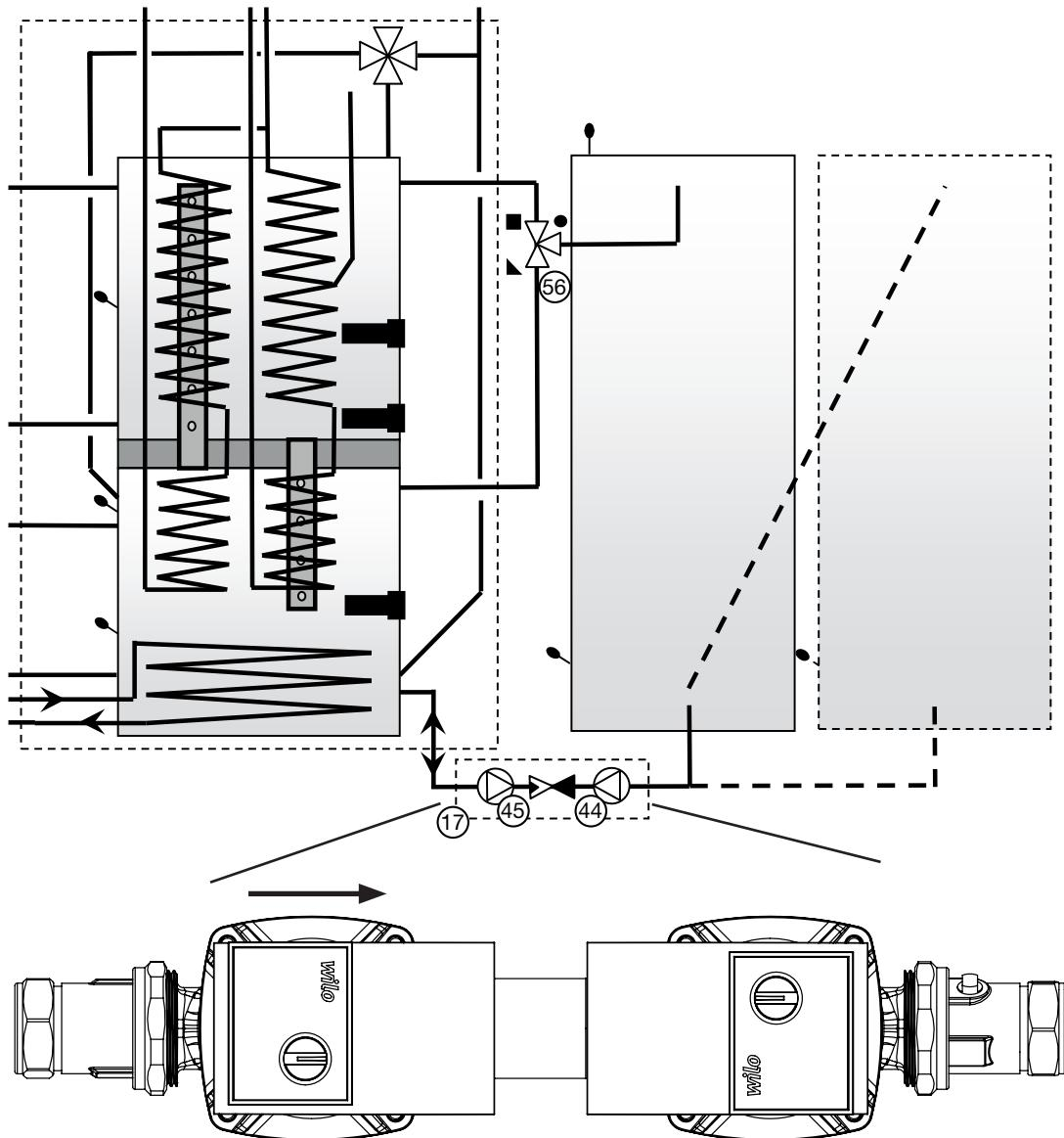
1. Laddutrustning (17) sköter flödet till och från den externa tanken. Växelventil (56) ser till att värme laddas till och från rätt del av EcoZenith.
