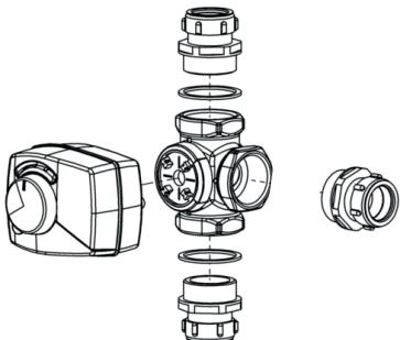
Smörj, täta med lin och montera ihop kopplingar och växelventil enligt bild.
