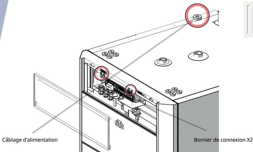
Le raccordement électrique doit être précédé d'un interrupteur omnipolaire et d'un dispositif à courant résiduel dans l'unité centrale. Le système doit être dimensionné de façon à respecter toutes les règles et exigences pertinentes (voir le manuel d'installation et de maintenance).
