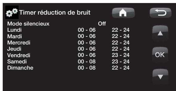
Le temps indiqué à gauche doit être inférieur à celui de droite pour que l'intervalle soit valable.
