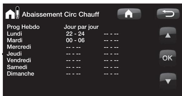
Exemple : Le lundi soir à 22h, la température est réduite à la température de réduction nocturne paramétrée. Le mardi matin à 6h, la température revient au niveau normal.
