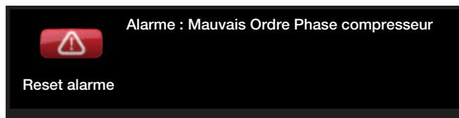
En cas d'erreur au niveau d'une sonde, par exemple, une alarme est déclenchée. Un message apparaît sur l'affichage pour donner des informations concernant l'erreur.
