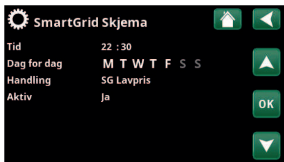
SmartGrid-funksjonen «SG Lavpris» planlegges hverdager klokken 22.30–06.00. Gå til menyen ved å velge «SmartGrid Skjema» i menyen «Avansert/Innstillinger».
