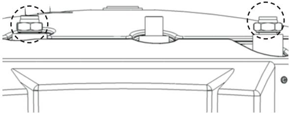
3. Skruva loss vinkel- och T-kopplingen tillsammans med kopparrören. Kopparrören behöver inte lossas från kopplingarna. Lämna kvar de nedre muttrarna då de passar vid återmonteringen.
