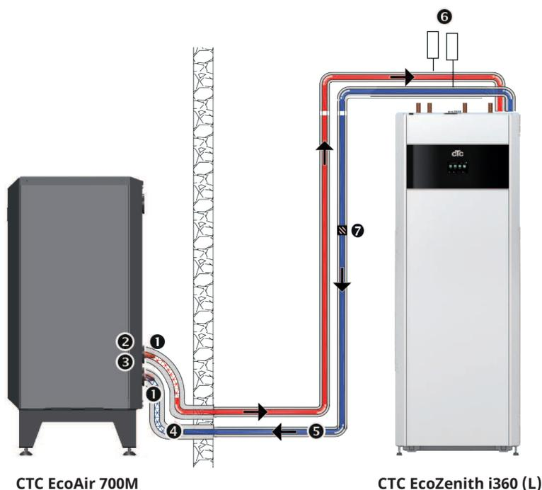
1. Cavo flessibile rinforzato con filo metallico e a tenuta di diffusione per acqua calda, min. 1" (accessorio CTC). Lunghezza del tubo flessibile: 1000 mm dal prodotto.
