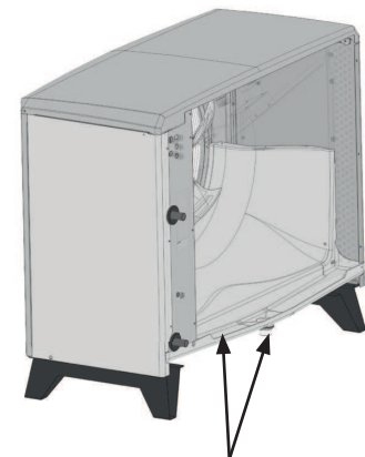
Kondenssiallas ja poistoputki
