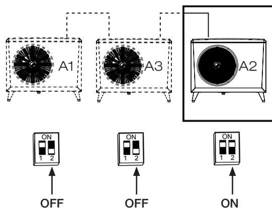
**!** Avec un raccordement en série, la dernière pompe à chaleur doit être réglée en position terminée.
