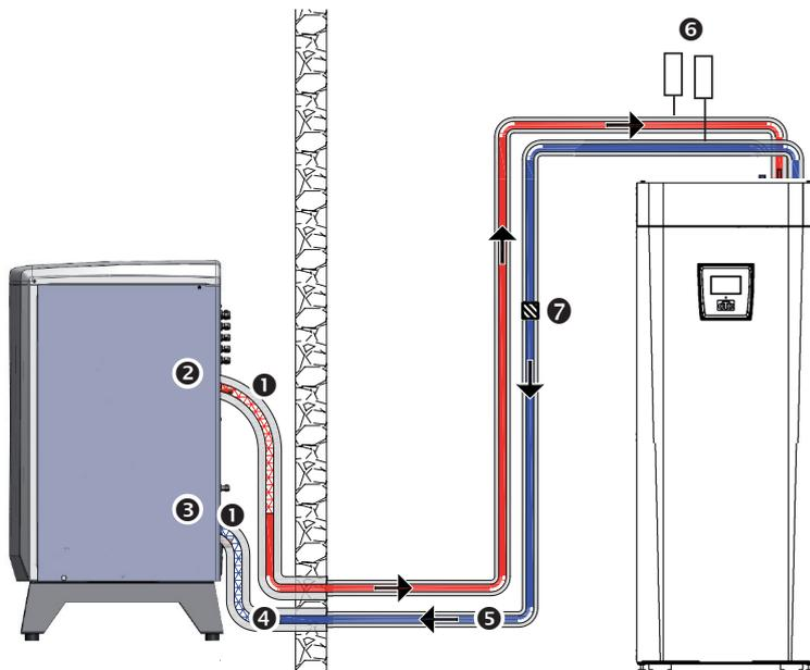
1. Flexible à armature métallique étanche pour eau chaude, min. 1". Longueur de flexible 1 000 mm depuis l'appareil.
