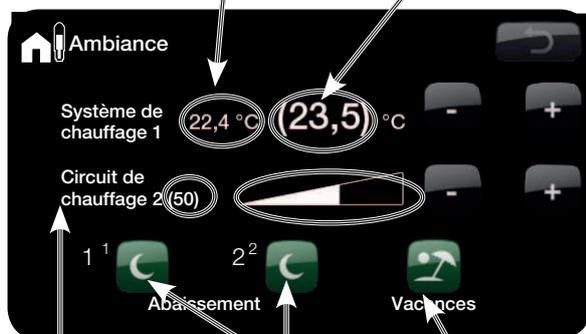
Réglage précis sans sonde d'ambiance. Pour permettre une modification majeure de la température, utilisez le réglage approximatif à droite.
