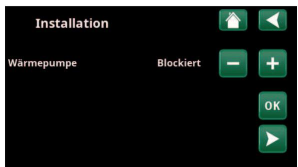
4. Geben Sie an, ob die Wärmepumpe 1 zulässig oder gesperrt ist. Für „Zulässig“ drücken Sie plus (+). Für „Gesperrt“ drücken Sie minus (-). Bestätigen Sie die Auswahl mit dem Pfeil nach rechts.
