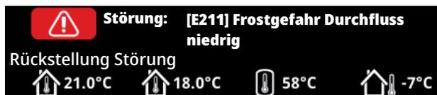
[E135] Frostgefahr (nach vier Störungsmeldungen wird eine neue Störung angezeigt [E218])
