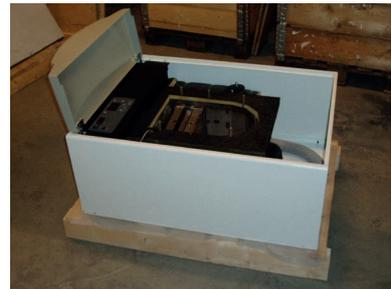
3. Heben Sie den Heizkessel an den unteren Ecken an.
