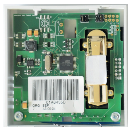
« Bouton d'apprentissage » (en dessous) pour connecter/apparier la sonde à la passerelle
