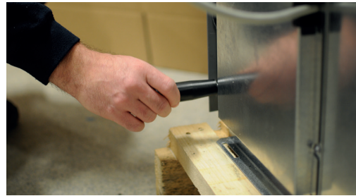
2. Kiinnitä kantokahvat (2kpl) kylmämoduulin alalaitaan.
