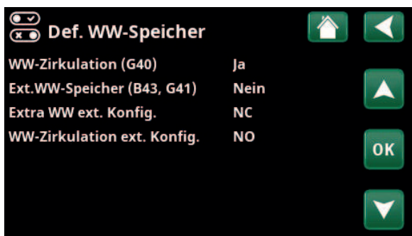
Menü: „Fachmann/Definieren/WW-Speicher“ In der Menüleiste „Extra WW ext. Konfiguration“ wird der Normalmodus für das externe Steuersignal festgelegt („standardmäßig offen (NO)“ oder „standardmäßig geschlossen (NC)“).
