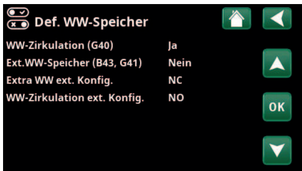
Menü: „Fachmann/Definieren/WW-Speicher“ Legen Sie für das externe Steuersignal einen Normalmodus (standardmäßig offen (NO) oder standardmäßig geschlossen (NC)) fest.
