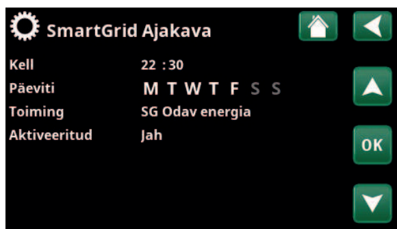
SmartGrid funktsioon „SG Odav energia” on ajastatud tööpäevadeks kell 22.30–06.00. Valige menüüs „Paigaldaja/Seadistus” valik „SmartGrid Ajakava”.
