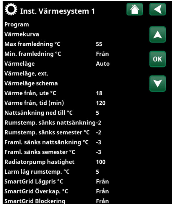
Del av meny "Avancerat/Inställningar/Värmesystem/Värmesystem 1".
