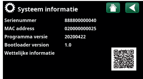
Menu: "Installateur/Systeeminformatie". Klik op de knop 'i' in de linkerbenedenhoek van het menu "Installateur" om in dit menu te komen.
