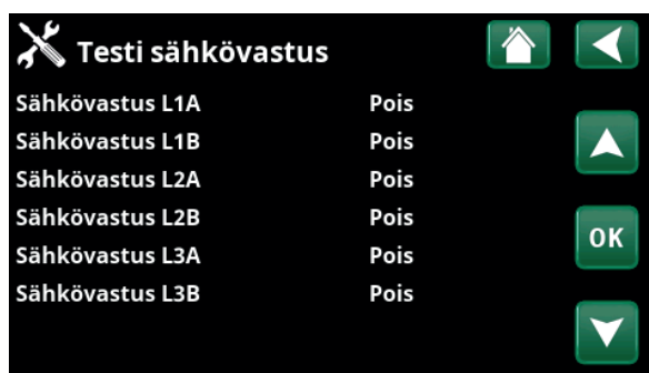
Valikko "Edistyneempi / Huolto / Testi / Sähkövastus".
