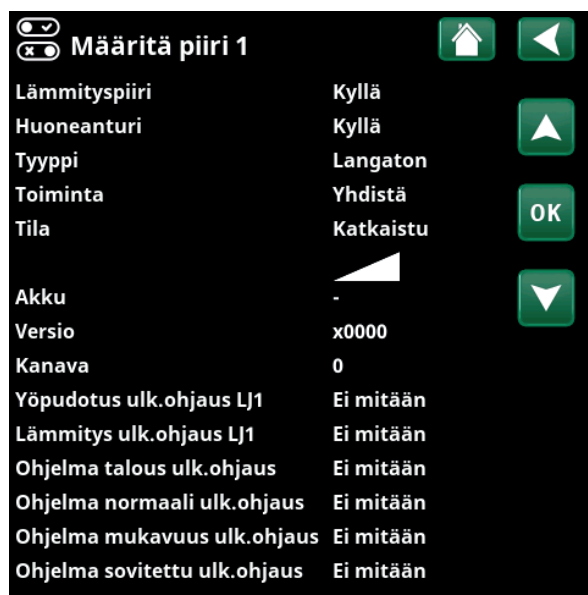
Valikko "Edistyneempi/Määrittele/Piiri/Piiri 1". Langaton huoneanturi on valittu.
