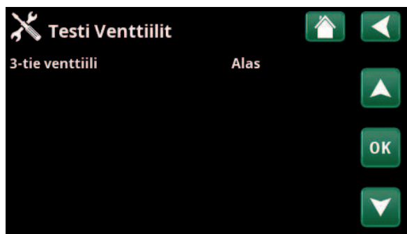
Valikko "Edistyneempi / Huolto / Toimintatesti / Venttiilit".
