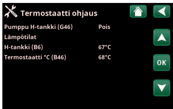
Valikko "Edistyneempi / Huolto / Toimintatesti / Termostaatti ohjaus".
