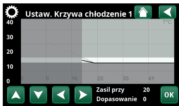
Menu „Instalator\Ustawienia\Chłodzenie\Krzywa chłodzenie/Ustaw. Krzywa chłodzenie”.
