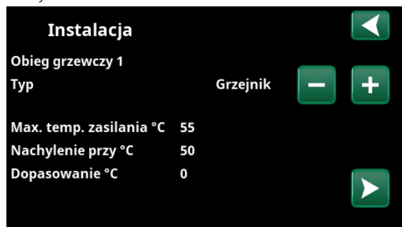
7. Określ, czy obieg grzewczy 1 ma zastosowanie do grzejników, czy do ogrzewania podłogowego. Za pomocą przycisków „+” i „-” przełącz się między opcjami „Grzejnik” i „Ogrzewanie podłogowe”. Potwierdź strzałką w prawo.
