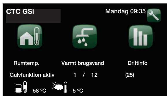
Eksempel på driftsdata til Driftsform 2, Dag 1 af 12 med aktuelt sætpunkt på (25) °C.
