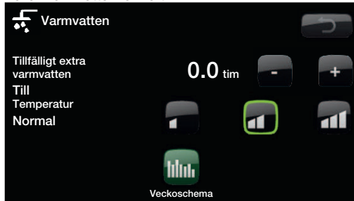
Val av varmvattenkomfort
