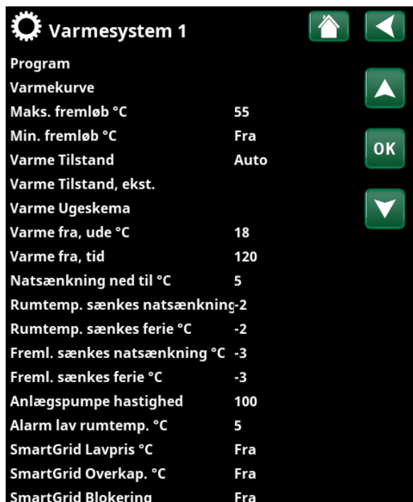
En del af menuen "Avanceret/Indstillinger/Varmesystem/Varmesystem 1".
