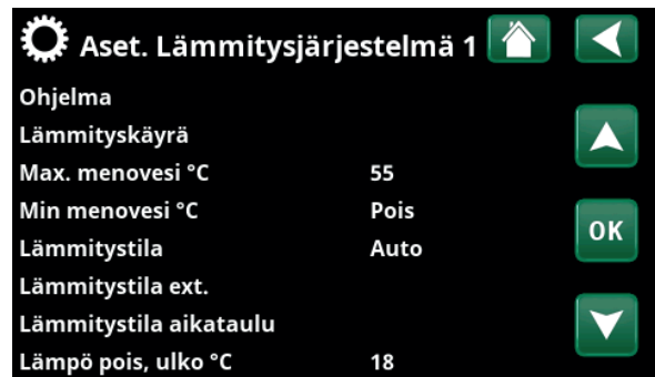
Osa valikkoa "Edistyneempi/Asetukset/Lämmitysjärjestelmä/LJ1".
