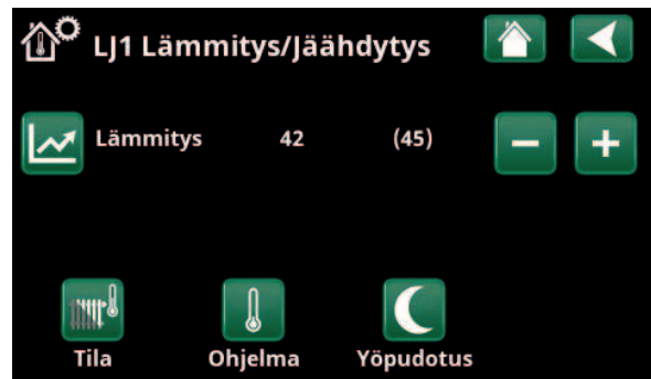
Valikko "Edistyneellinen/Määrittele/Lämmitysjärjestelmä/LJ1". Lämmitysjärjestelmässä ei ole huoneantureita. Asetuspiste (menoveden lämpötila 45 °C) näkyy suluissa, nykyinen menoveden lämpötila 42 °C näkyy asetuspisteen vasemmalla puolella.
