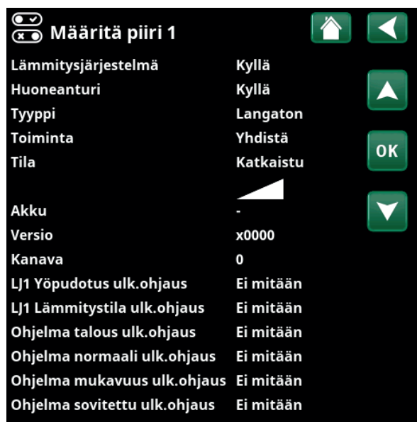
Valikko "Edistyneempi/Määrittele/Lämmitysjärjestelmä/LJ1". Langaton huoneanturi on valittu.
