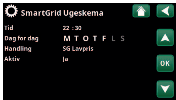
SmartGrid-funktionen "SG Lavpris" er planlagt til hverdage kl. 22.30-06.00. Gå til menuen ved at vælge "SmartGrid-ugeskema" i menuen "Avanceret/Indstillinger".
