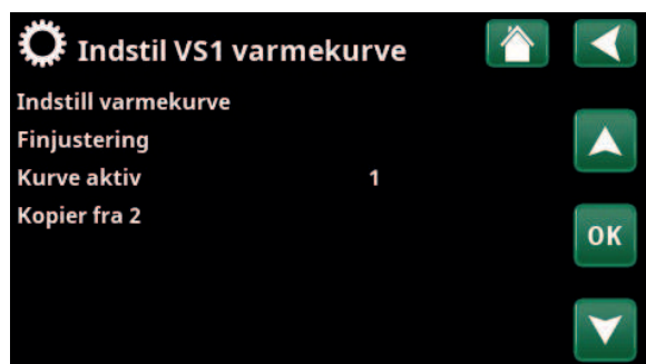
Menu: "Avanceret/Indstillinger/Varmesystem/Varmesystem 1"/Varmekurve". Kurve aktiv: #1.
