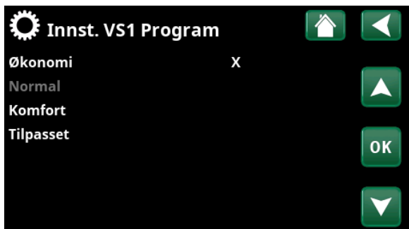
Menyen «Avansert/Innstillinger/Varmesystem/Varmesystem 1/Program».
