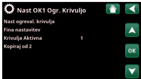
Meni: »Instalater/Nastavitve/Ogrevni krog/Ogrevni 1/ Ogrevna krivulja«. Aktivna krivulja: #1.
