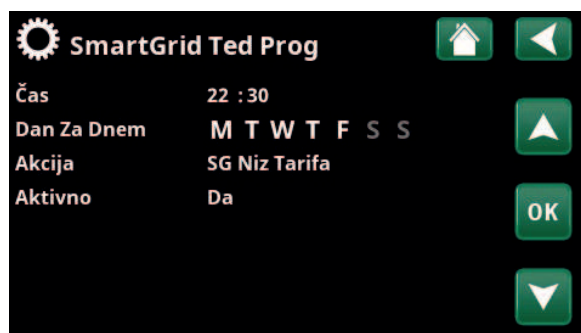
Funkcija SmartGrid »SG Nizka Tarifa« je predvidena med tednom od 22:30 do 06:00. V meni vstopite tako, da v meniju »Instalater/ Nastavitve« izberete parameter »SmartGrid Ted Prog«.
