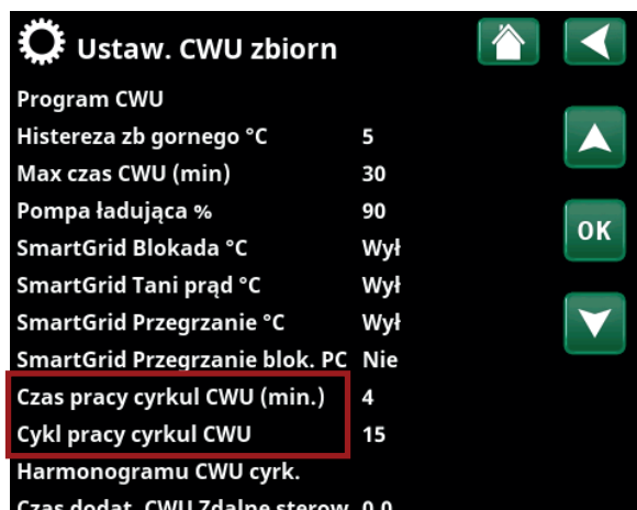
Część menu „Instalator/Ustawienia/CWU”.
