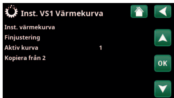
Meny "Avancerat/Inställningar/Värmesystem/Värmesystem 1/ Värmekurva".
