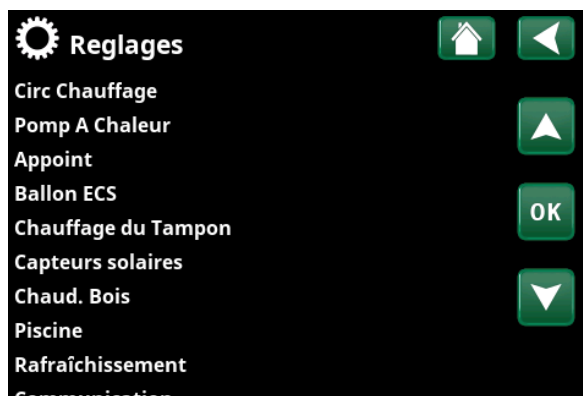
Partie du menu « Installateur/Réglages » pour CTC Ecologic.
