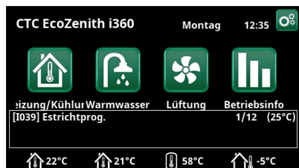
Beispiel: Estrichprogramm Temperatur, Tag 1 von 12 mit aktuellem Sollwert von 25 °C.
