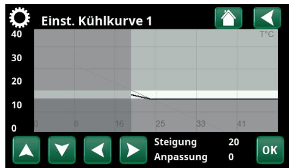
Menü „Fachmann/Einstellungen/Kühlung/Kühlkurve/Einst. Kühlkurve“.
