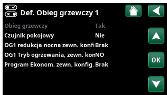
Menu „Instalator/Definiowanie/Obieg grzewczy/Obieg grzewczy 1”.
