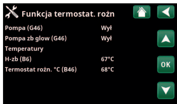
Menu: „Instalator\Serwis\Funkcja termostat. różn”.
