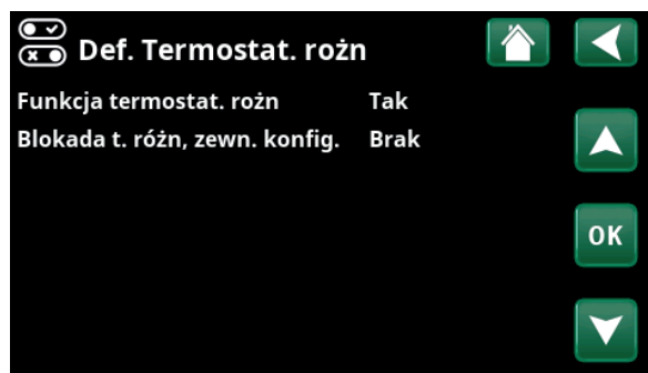
Menu: „Instalator\Definiowanie\Termostat. różn”.
