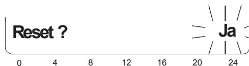
Nach dem Bestätigen mit der Taste <OK> erfolgt der Reset des entsprechenden Parameters oder Zählers.
